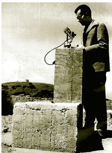
Figura 1.3: Instrumentación para la prospección astronómica. Hubo que inventársela. Valga como muestra este piroheliómetro en desuso del Observatorio Meteorológico de Izaña, que se empleó para medir la transparencia atmosférica, gracias a un sistema de medida que diseñamos y que nos construyó la entonces Junta de Energía Nuclear.
